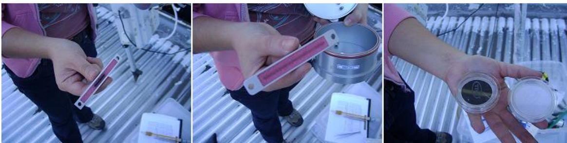
Figura 28. Espuma de poliuretano (EPUs) y filtro de material particulado ultrafino después de muestreo.
