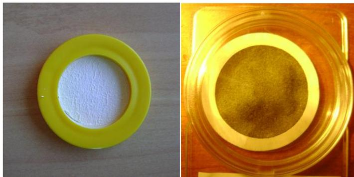
Figura 13. Filtro utilizado por equipo Harvard Impactor antes y después del muestreo.
