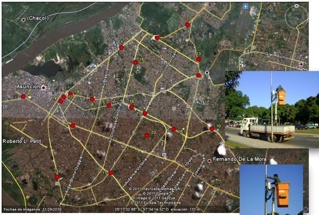
**Figura 26. Red de tubos pasivos de NO<sub>x</sub> y SO<sub>2</sub>**
