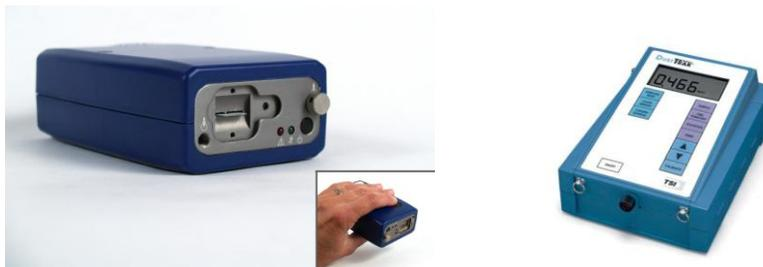
Figura 14. Equipos utilizados para el monitoreo continuo de hollín (izquierda) y  $MP_{2,5}$  (derecha).
