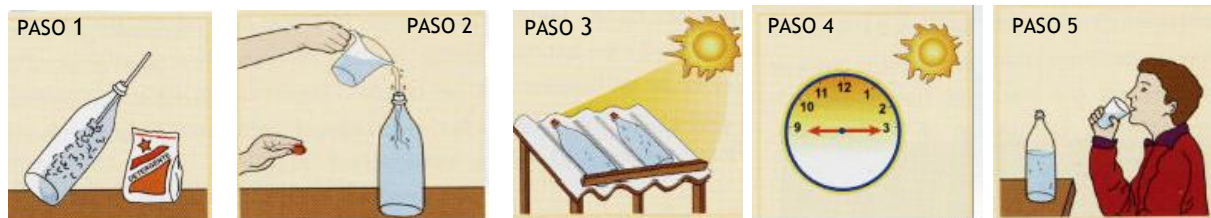
Figura 2 Procedimiento para Purificar el agua por medio del Método SODIS
